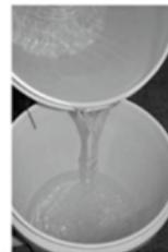
Agregue agua al balde y baje el filtro por debajo de la parte inferior del balde para iniciar el flujo. Entre mas distancia haya entre el filtro y la linea superior del agua, más rápido fluirá el agua.
