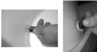
TALADRO ELECTRICO NO ES NECESARIO. HUECO SE PUEDE HACER A MANO. Perfore un hueco a un lado del balde girando la broca de mano (C) y dejando de 3 a 4 centímetros de espacio por encima de la parte inferior del balde. esto ayudará a prevenir que los sedimentos entren al filtro. ASEGURESE DE QUE EL HUECO PERFORADO EN EL BALDE QUEDE LO MAS LISO Y LIMPIO POSIBLE PARA EVITAR QUALQUIER FUGA.
